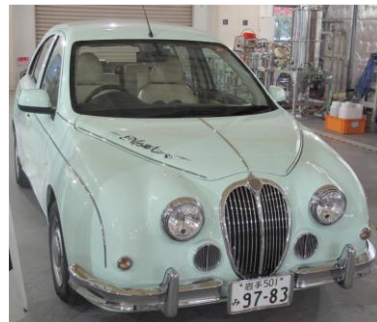
繊維強化複合材料製ボンネット（改質リグニンを使用）を取り付けた試験車両 宮城化成/産業技術総合研究所より提供 協力：光岡自動車
